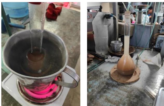
Figura 5. Proceso para determinar la densidad de sólidos (arena y finos)
