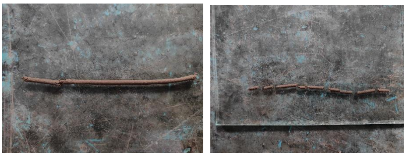
Figura 3. Proceso de elaboración de cilindros para determinación de límite plástico
