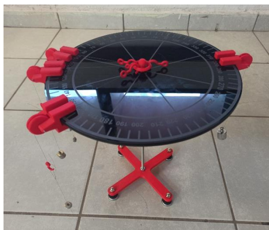
Fig. 6 Mesa de fuerzas ensamblada.
