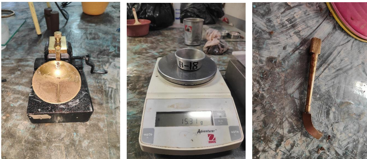
Figura 2. Proceso de determinación de límite líquido.
