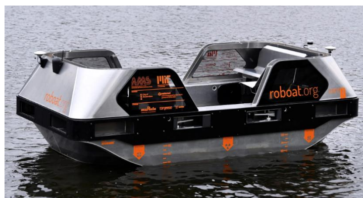
Figura 5 Prototipo funcional del Roboat en los canales de Ámsterdam.
