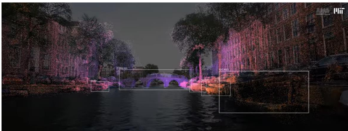
Figura 6 Vista del sensor LIDAR para detectar y esquivar los obstáculos y objetos.
